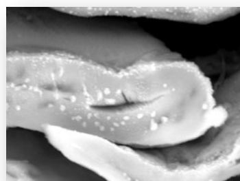
無機微粒子が複合化された難燃パルプの SEM 画像（倍率 5, 500 倍）
