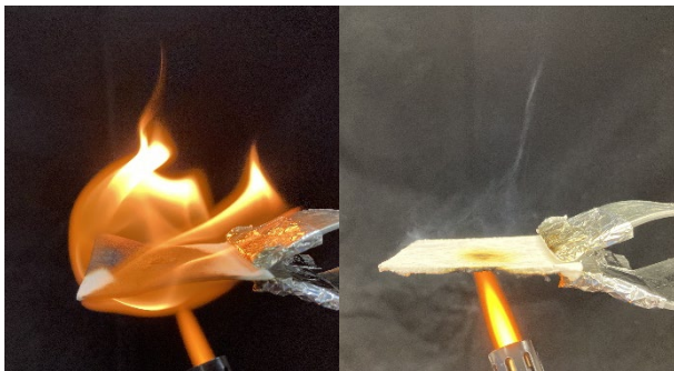
難燃セルロースの燃焼試験 (左：パルプ 右：難燃セルロース)
