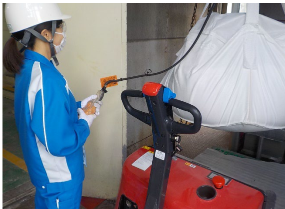
クレーンを用いた原料仕込み作業
