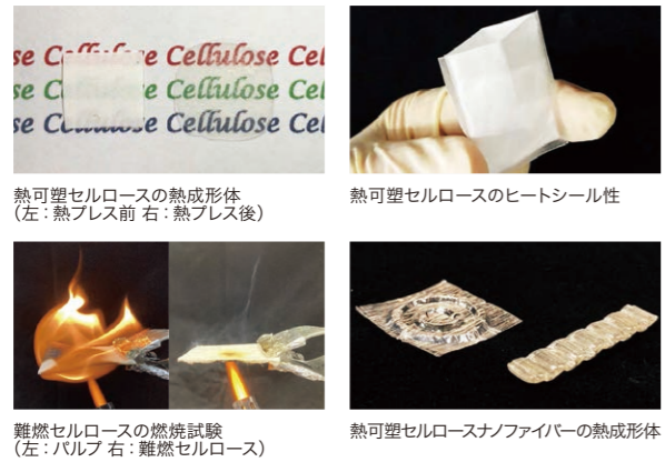
熱可塑性セルロースの熱成形体 (左:熱プレス前 右:熱プレス後) 熱可塑性セルロースのヒートシール性 難燃セルロースの燃焼試験 (左:パルプ 右:難燃セルロース) 熱可塑性セルロースナノファイバーの熱成形体
