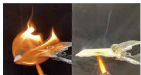
難燃セルロースの燃焼試験 (左: パルプ 右: 難燃セルロース)
