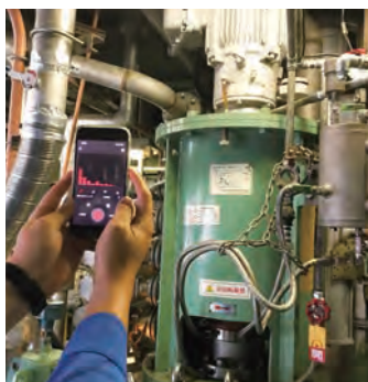
スマートフォン(既存インフラ)にてセンシング対象機器の音を収集
