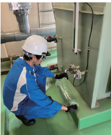
脱臭塔の臭気調査
