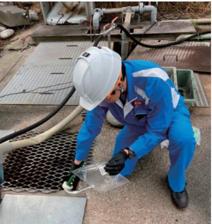
排水ビットの臭気調査
