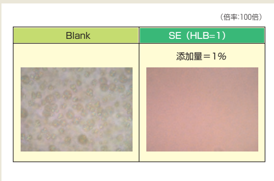
図5 徐冷固化したパーム油の偏光顕微鏡写真
