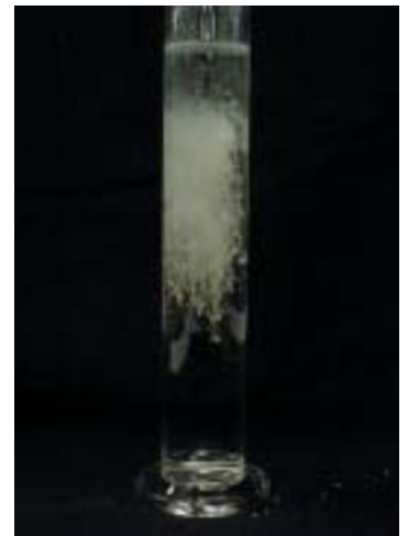
写真1 水中で崩壊・分散する顆粒水和剤
