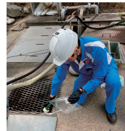
排水ピットの臭気調査
