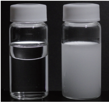
レオクリスタを用いて調製した乳化物 (左) CNF無添加 (右) 0.2% CNF添加
