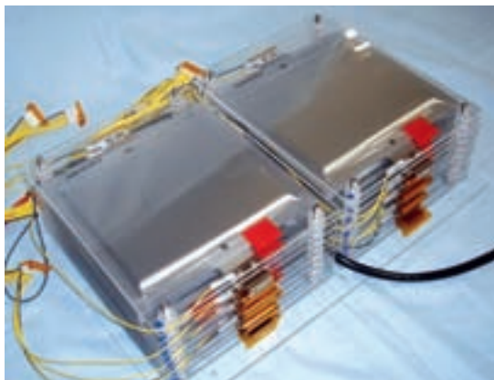
リチウムイオン電池をモジュール化してテストしています。
