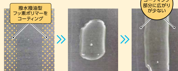
図2 ステンレス板上での油の濡れ広がり挙動
