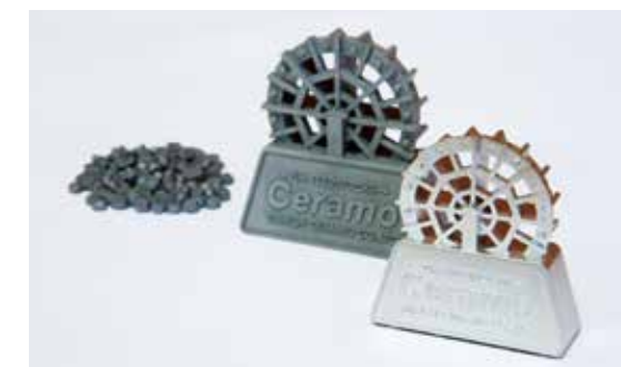
図6 MIM用コンパウンド、成形体、焼結体例
