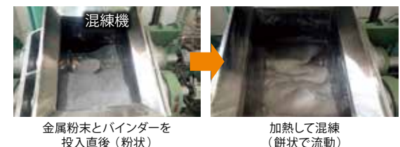
図3 MIM用コンパウンドの混練状態
