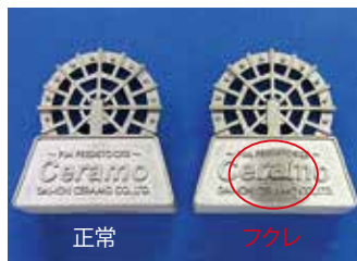
図8 フクレ不良例 (写真は焼結体)
