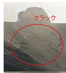
図7 内部クラック不良例 (写真は切断した焼結体)
