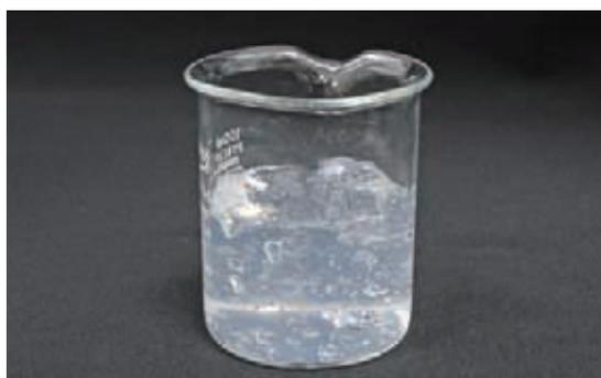
図1 CSNF水分散物 (固形分2wt%) の外観
