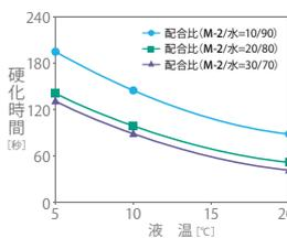
図3 ポリグラウトM-2の硬化時間
