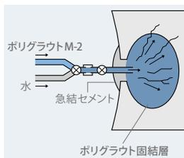
図1 ポリグラウトM-2の工事例
