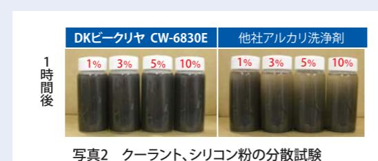
写真2 クーラント、シリコン粉の分散試験
