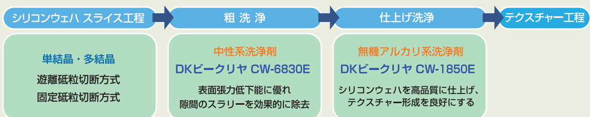
図1 シリコンウェハの洗浄工程
