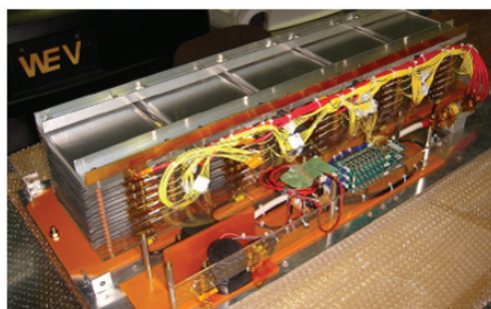
写真3 急速充放電を可能にする1.5kWh電池モジュール
