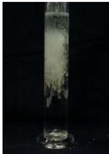
写真1 水中で崩壊・分散する顆粒水和剤
