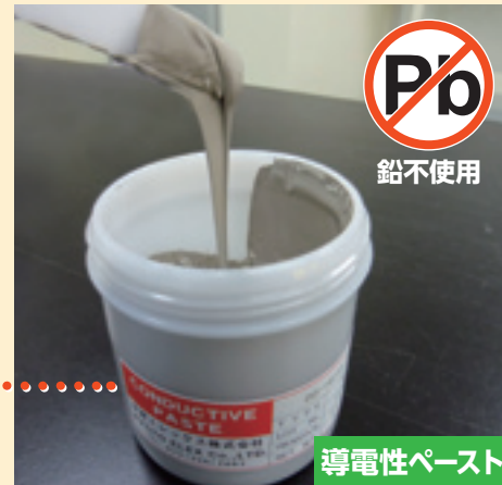
導電性ペーストを太陽電池セルの表面に印刷後、焼成して、集電線を形成。
