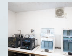
フィラメント式3Dプリンターで金属やセラミックスを造形
