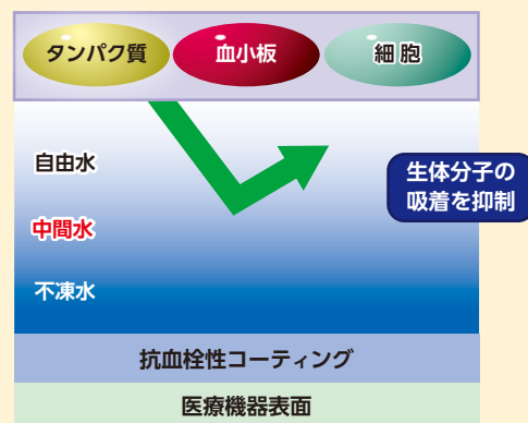
図2 生体適合性高分子表面の水和状態イメージ 5)
