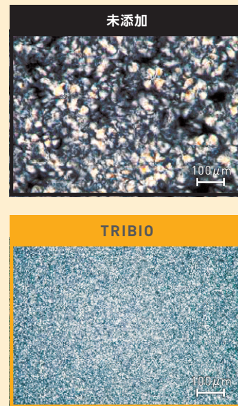
図2 金型脱型後の偏光顕微鏡写真 (TRIBIO T-310MBを10%添加)
