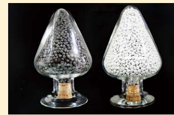
図3 3Dプリンター用材料 (左: SUS316L, 右: ジルコニア)
