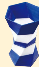
図11 異種材料の造形例：カップ (ジルコニア焼結品)
