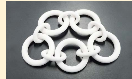
図10 可動域を持った造形例：リング (ジルコニア焼結品)
