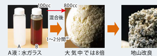
図2 スーパーSRFの発泡硬化特性
