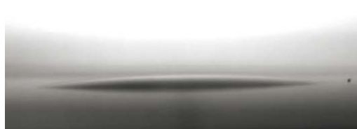
図4 ショ糖-アルキレンオキシド-脂肪酸エステルを内部添加したEVAフィルムの水滴接触角測定画像
