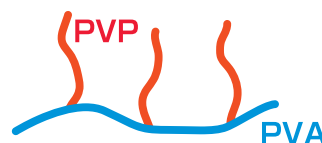
図1 PVA-PVPグラフトコポリマーのイメージ図
