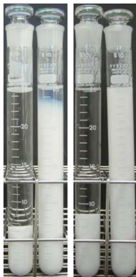
酸化チタン 炭酸カルシウム 左(ブランク)、右(CSNF0.1%含有)
